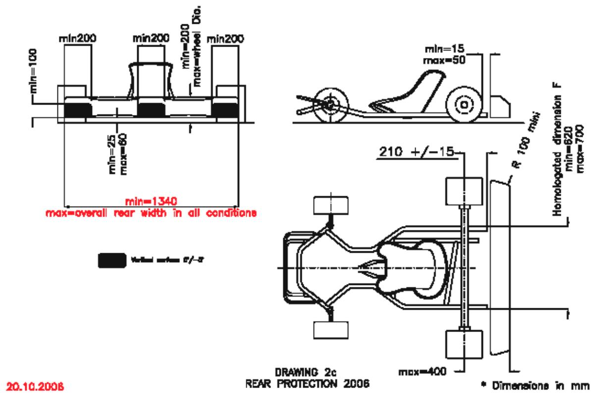
Рисунок 3 – задний пластиковый отбойник
